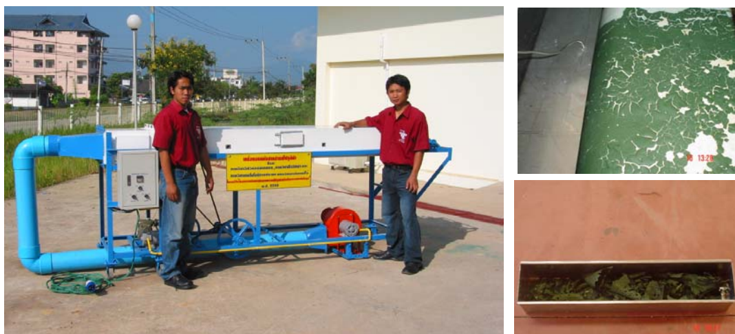
เครื่องอบแห้งอุโมงค์ลมร้อน และสาหร่ายแห้งที่ได้จากการอบที่ 80^{\circ}\text{C}
